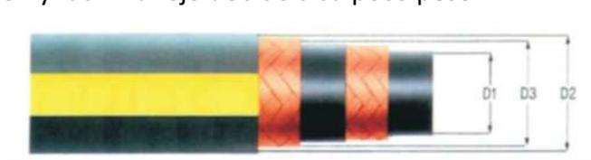
Además, presentan una clara ventaja con respecto a las mangueras de caucho con refuerzos metálicos porque eliminan el riesgo de corte o pinchazo en las manos de los operadores durante su manipulación. En ocasiones estos refuerzos metálicos se oxidan y se parten, con la posibilidad de salir al exterior atravesando el recubrimiento de caucho en forma de alambres punzantes.
